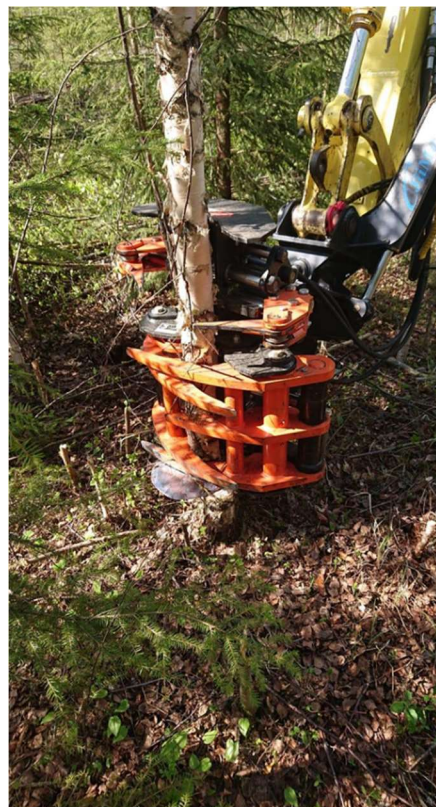
KUVA 2. Puu puristuneiden leukojen ja törmäyslevyn välissä.
